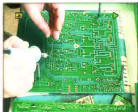
SOUDURE A LA MAIN
