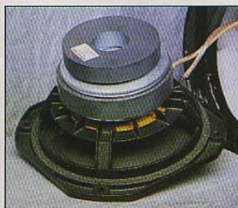
Haut-parleur de médium : un modèle de 17 cm fabriqué sur cahier des charges par Audax.
