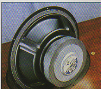
Les haut-parleurs de grave, d'origine Peerless, sont des modèles de Ø 250 mm.
